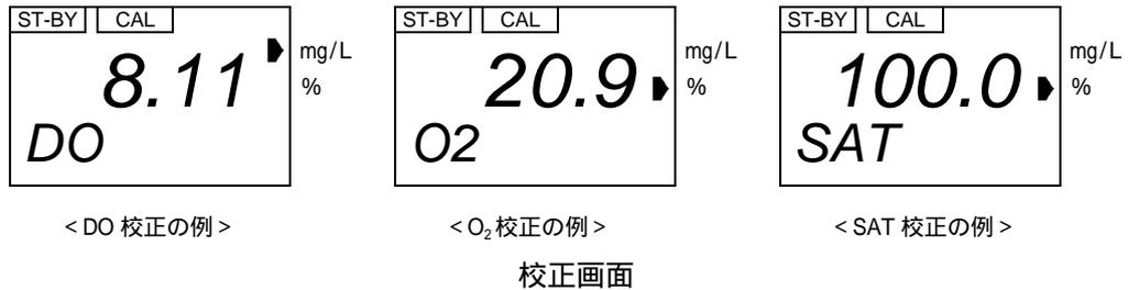
電極を空中に置く.....電極を純水で洗浄してから，空气中に置いてください。
