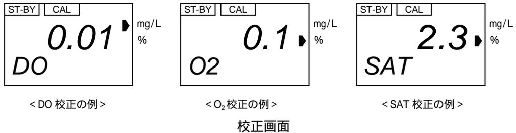
ゼロ校正を開始する.....約1~2分後、指示が0付近で安定したら、**[ENT]**を押してください。安定判別オンのときは、ウエイト表示(WAIT)が点滅します。安定判別オフのときは、ゼロ校正が確定します。
