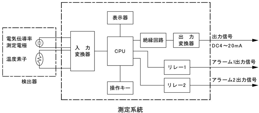
この電気伝導率計の変換器では、温度補償を含め、次のように演算しています。内極と外極からなる電気伝導率測定電極と温度素子からの信号を、入力変換器で変換します。これをCPU(中央演算処理装置)で読み込んで温度補償などを演算し、25°Cの電気伝導率値を表示器へ表示します。同時に、絶縁回路を経て出力変換器でDC4~20mAの伝送信号として出力します。
