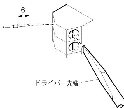
ねじクランプ式端子台と端末処理
