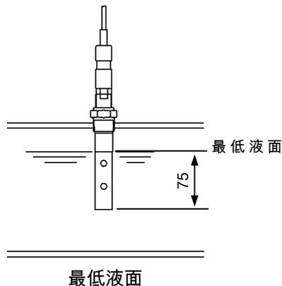
(d) 検出器から遮蔽物までの距離は下図「遮蔽物からの距離」程度確保してください。
